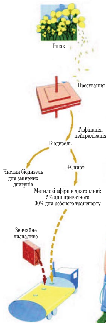
Рис. 4. Принципова схема виробництва і використання біодизеля та біоетанола.
